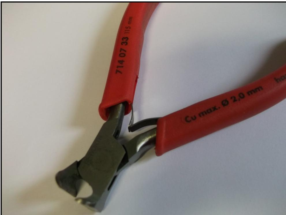
Mit dieser Zange kommt man maximal nah an der Kabelbinder-Kopf, und kann den Überstand effektiv beseitigen
